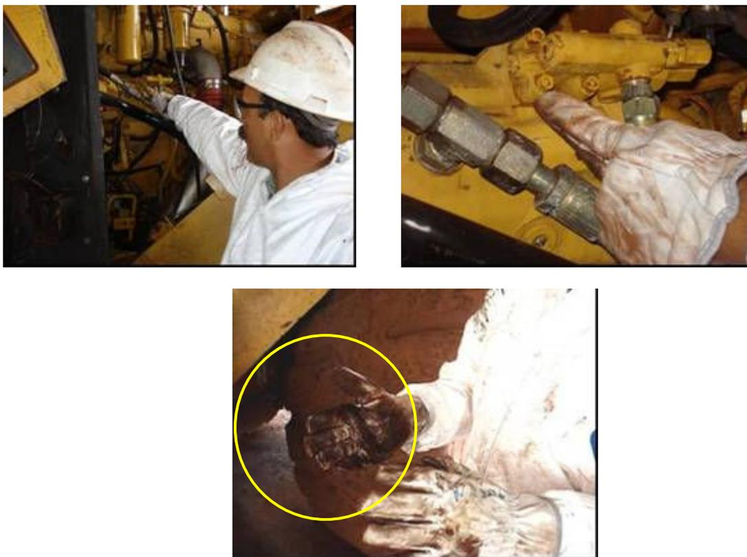
FIGURA 02 : A DIMENSÃO DO PARAFUSO E A LUVA CONTAMINADA
