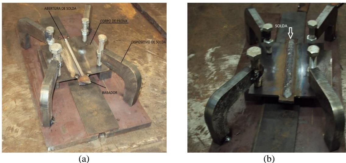
Figura 2: a) Desenho Final do Corpo de prova do metal base do Aço ASTM A572
