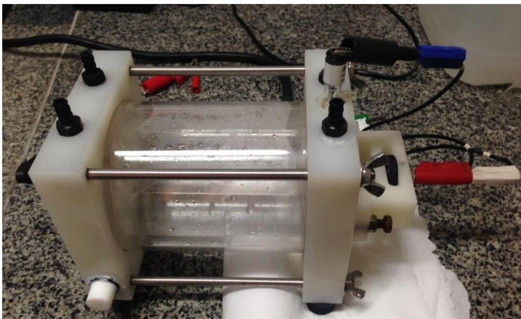
Figura 6: Célula de corrosão eletroquímica fabricada na PUC.
