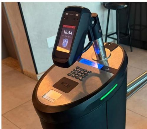
Figura 9 : Dispositivo iDFace integrado à Catraca.
