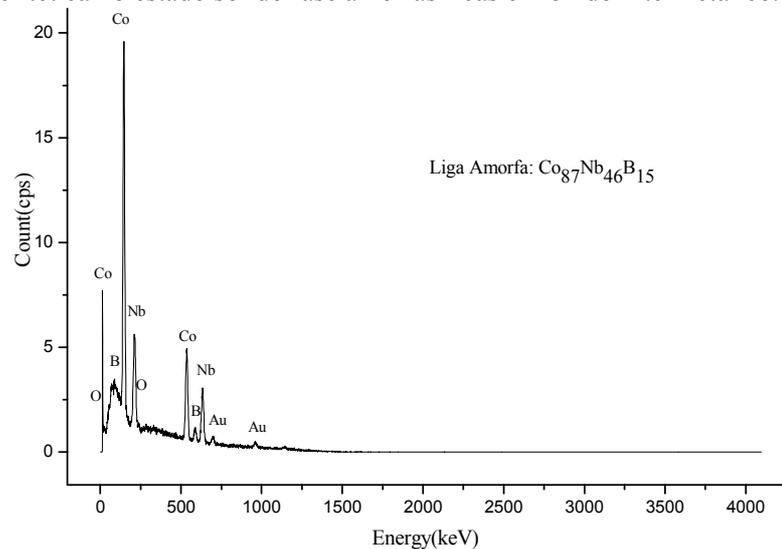
**Figura 4.** Análise elemental do EDS da liga amorfa  $\text{Co}_{87}\text{Nb}_{46}\text{B}_{15}$ .
