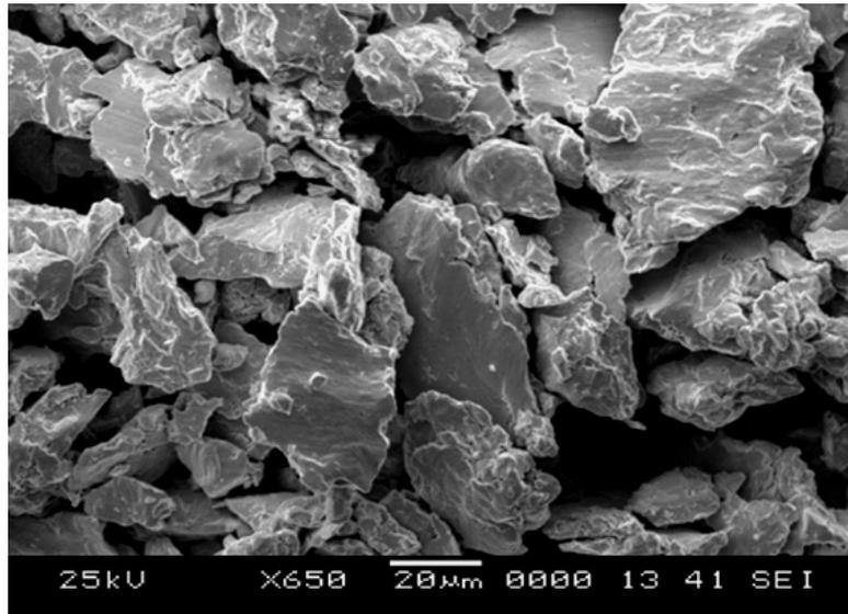
**Figura 3.** MEV da liga amorfa  $\text{Co}_{87}\text{Nb}_{46}\text{B}_{15}$  formando grãos irregulares.
