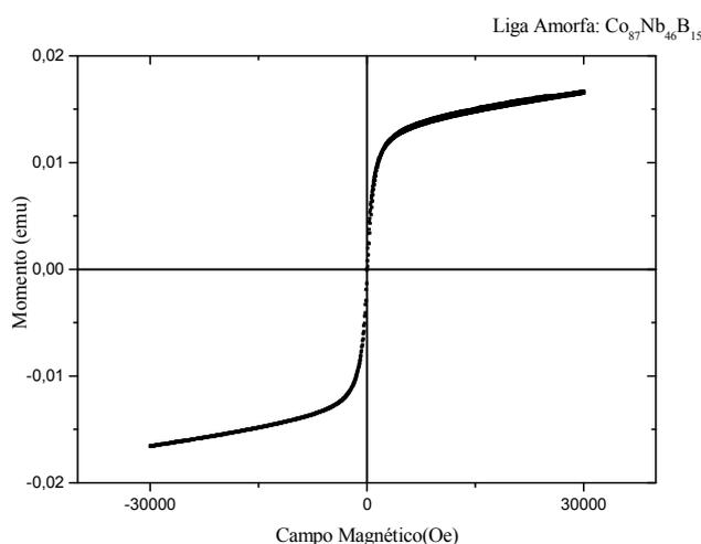
**Figura 5.** Curva de histerese da liga  $\text{Co}_{87}\text{Nb}_{46}\text{B}_{15}$ .
