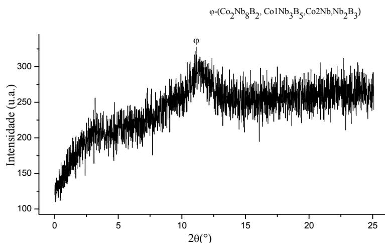
**Figura 2.** Espectro de difração de raios X na liga amorfa  $\text{Co}_{87}\text{Nb}_{46}\text{B}_{15}$ .
