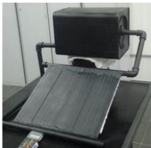
**Figura 03:** Superfície do coletor pintada de preto
