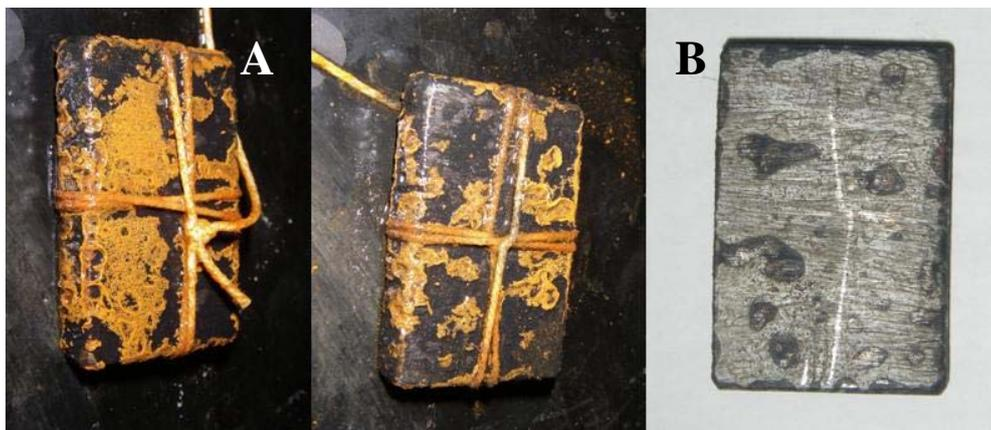
Figura 14: **Corrosão X Água Destilada:** **A)** Chapa de aço carbono retirada do galão após 11 dias submersa em água destilada; **B)** Chapa aço carbono após lavagem em água corrente para melhor visualização (Almeida, 2008)
