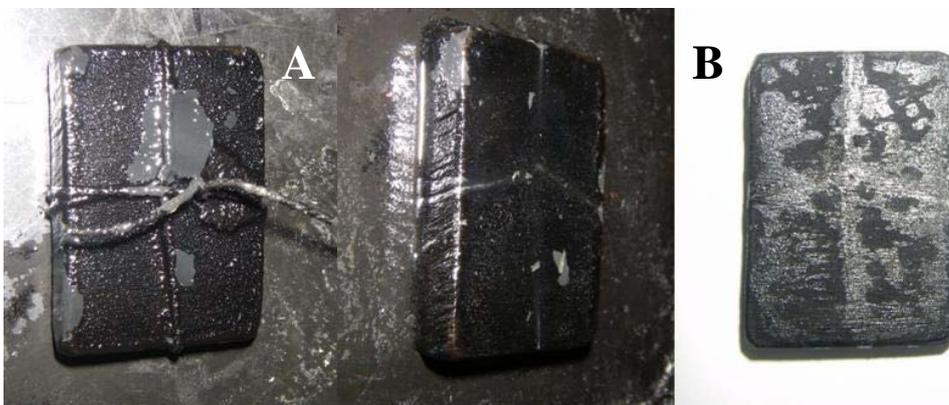
**Figura 11: Corrosão X Água TQ 6BE:** **A)** Chapa de aço carbono retirada do galão após 11 dias submersa em água de produção do TQ 6BE; **B)** Chapa aço carbono após lavagem em água corrente para melhor visualização (Almeida, 2008)
