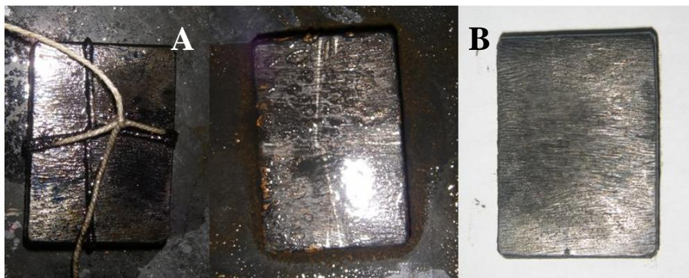
Figura 13: **Corrosão X Água TO:** **A)** Chapa de aço carbono retirada do galão após 11 dias submersa em água de produção do tratador eletrostático de óleo; **B)** Chapa aço carbono após lavagem em água corrente para melhor visualização (Almeida, 2008)
