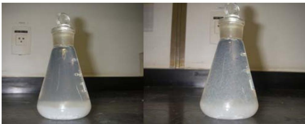
Figura 6: **Amostra de água para análise de sulfeto de hidrogênio:** Água de produção coletada em Erlenmeyer contendo 0,75 mL de acetato de zinco e 0,25 mL de hidróxido de sódio. É possível visualizar o sulfeto de hidrogênio precipitado devido à presença do acetato de zinco (Almeida, 2008)
