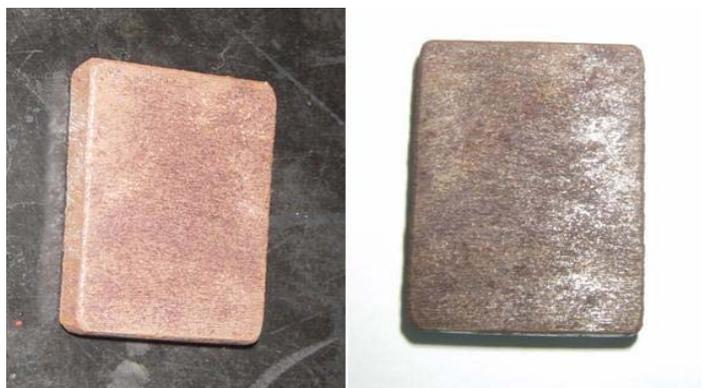
Figura 15: **Corrosão X Ambiente Marinho (atmosfera):** Chapa de aço carbono após 11 dias de exposição ao ambiente marinho.
