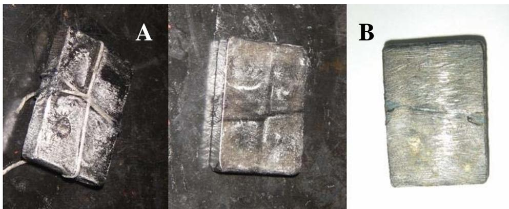
Figura 12: **Corrosão X Água Slop BE:** **A)** Chapa de aço carbono retirada do galão após 11 dias submersa em água de produção do slop tanque de BE; **B)** Chapa aço carbono após lavagem em água corrente para melhor visualização (Almeida, 2008)
