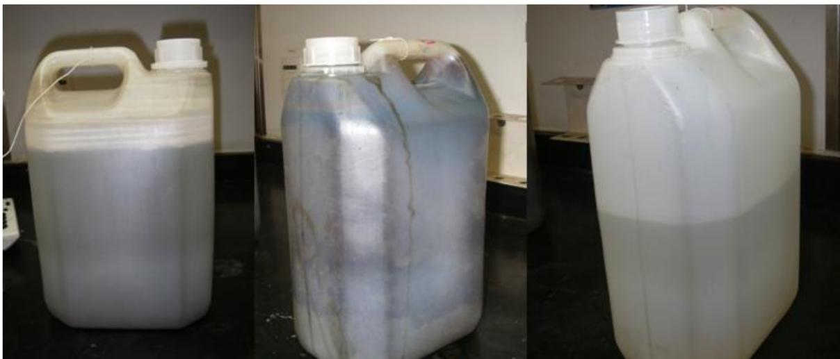
Figura 5: **Sistema fechado de produção de sulfeto de hidrogênio:** Galões contendo água de produção onde as amostras de aço carbono foram submersas (Almeida, 2008)
