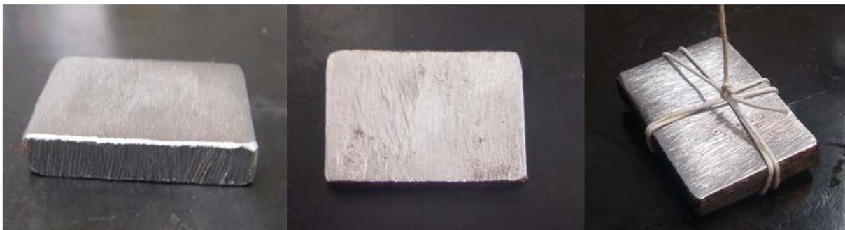
Figura 4: **Amostras de Aço Carbono:** Peças de aço carbono (ASTM A36) não galvanizado antes de serem submetidas ao tratamento (Almeida, 2008)
