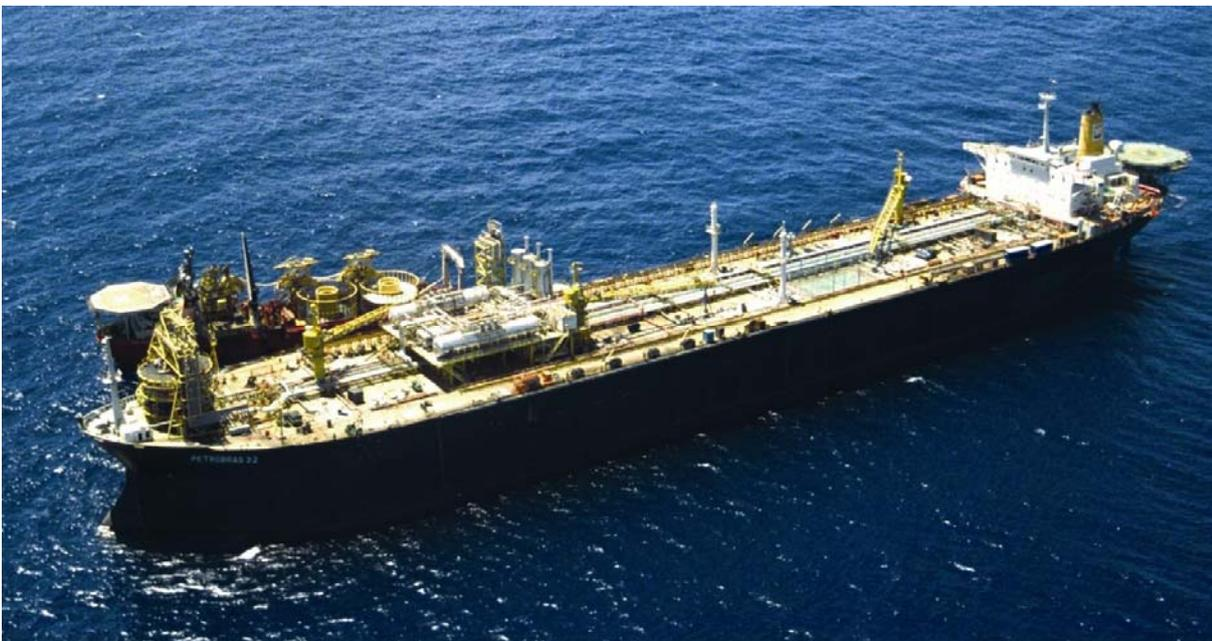
Figura 2: **Plataforma tipo FPSO:** Unidade Marítima FPSO (Floating Process Storage and Offloading) que processa, armazena e transfere óleo
