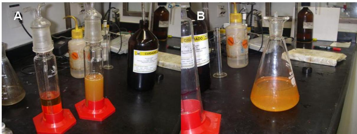
Figura 8: **Iodometria:** **A)** Adição de Iodo nos fracos lavadores; **B)** Transferência da amostra para o Erlenmeyer (Almeida, 2008)
