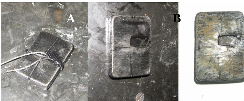
**Figura 10: Corrosão X Água TQ 6BB:** **A)** Chapa de aço carbono retirada do galão após 11 dias submersa em água de produção do TQ 6BB; **B)** Chapa aço carbono após lavagem em água corrente para melhor visualização (Almeida, 2008)
